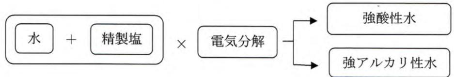
強酸性水・・・pH2.7 以下 酸化還元電位 1,100mv 以上 溶存塩素濃度 20ppm 以上
